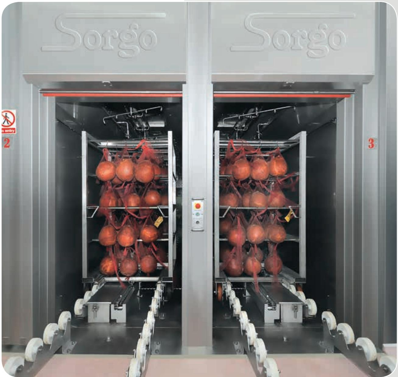
Ob hängende oder liegende Produkte – durch das ausgeklügelte Umluftverteilungssystem wird eine absolut gleichmäßige Temperaturverteilung erreicht, wobei die Kerntemperaturmessung über neuartige Funkfühler geregelt wird.
