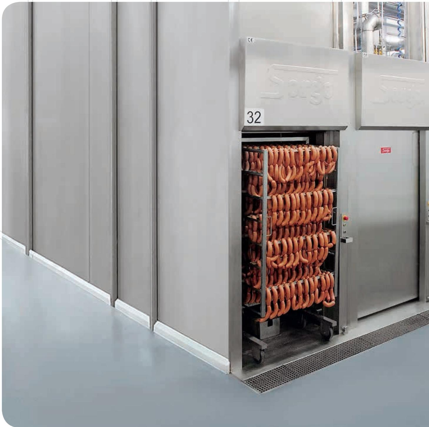
Die Sorgo-Konti-Anlagen können im Nachtbetrieb ohne Bedienpersonal betrieben werden. Vor dem Ende der Arbeitszeit kann die Anlage beschickt werden und alle Prozesse laufen vollautomatisiert ab – das gekühlte Fertigprodukt kann am nächsten Tag entnommen werden.
