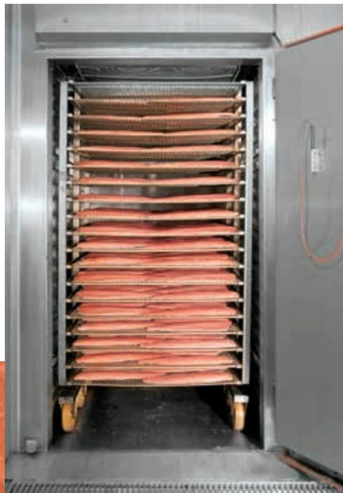
*Ein speziell für die thermische Veredelung von Fisch entwickeltes Luftführungssystem garantiert Ihnen höchste Produktqualität bei geringem Gewichtsverlust.*
