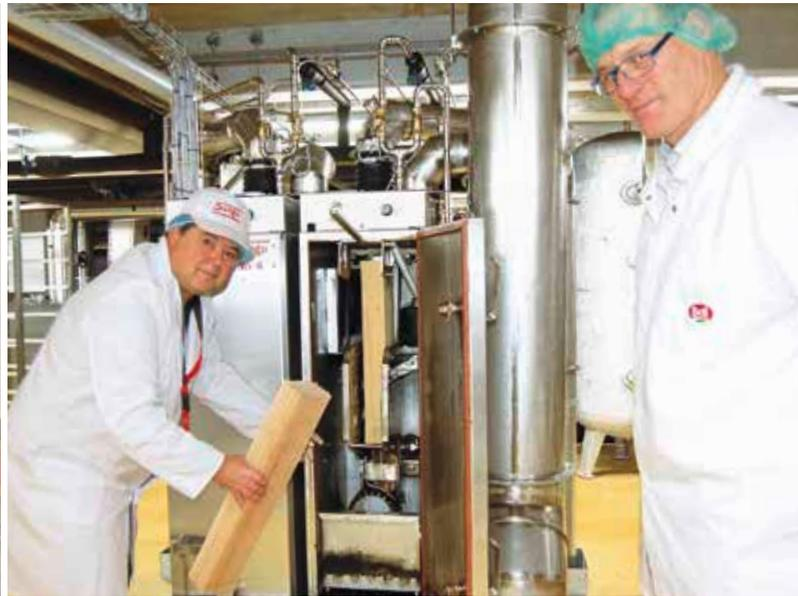
Die Steuerung der Anlage ist einfach zu bedienen, die Reiberaucherzeuger werden mit Vierkanthölzern aus Buche gefüllt./
