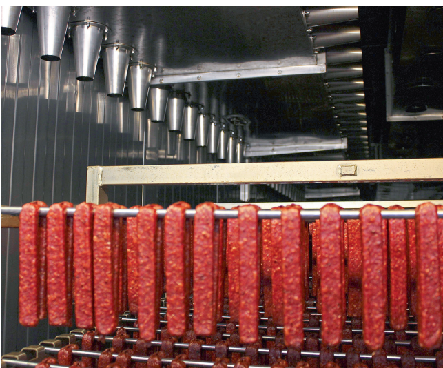
Technische Herausforderung: Die 4-Kanal-Technologie sorgt für absolute Gleichmäßigkeit bei Rauchverteilung und Gewichtsverlust.
